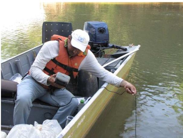
**Figura 28.** Medições de oxigênio dissolvido, saturação de OD, condutividade, temperatura da água, temperatura do ar, pH, com o auxílio de uma sonda multi-parâmetros, durante as atividades de monitoramento da ictiofauna, julho de 2015.
