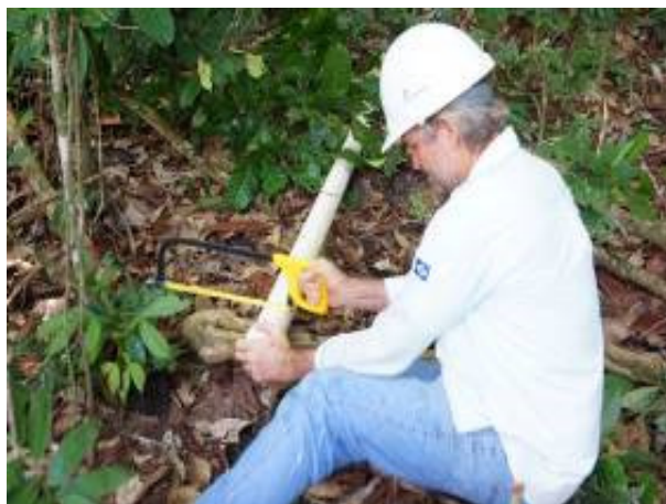
Foto 10. Mostrando procedimento da ranhuras realizada no cano de PVC.
