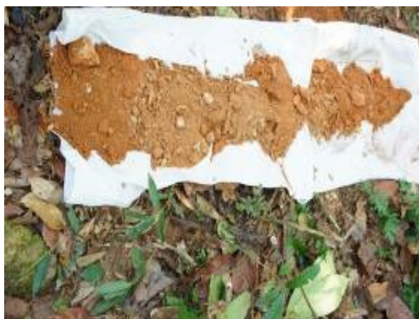
Foto 14. Amostra de coleta de solo dos poços para descrição do perfil pedológico.
