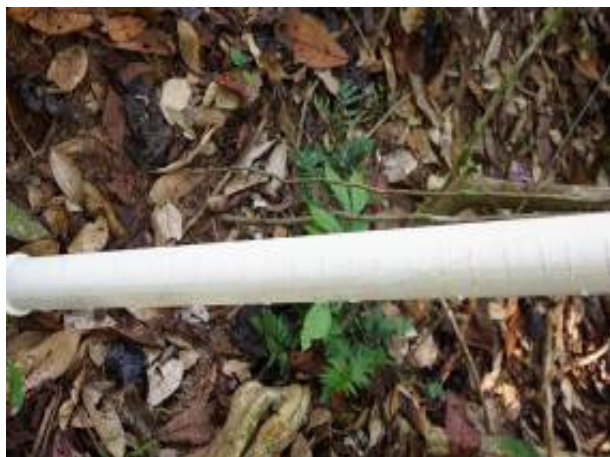
Foto 9. Detalhe das ranhuras realizada no cano de PVC.
