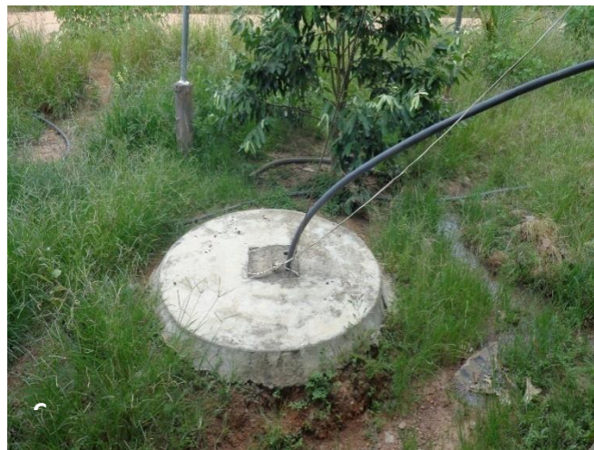
Figura 1. Pontos para monitoramento da qualidade da água sem necessidade de sondagem devido à utilização de poços existentes (PM01 ao PM04) na área de influência da UHE Teles Pires. A = poço de monitoramento 01 (PM01); B = poço de monitoramento 03 (PM03) e C = poço de monitoramento 04 (PM04).
