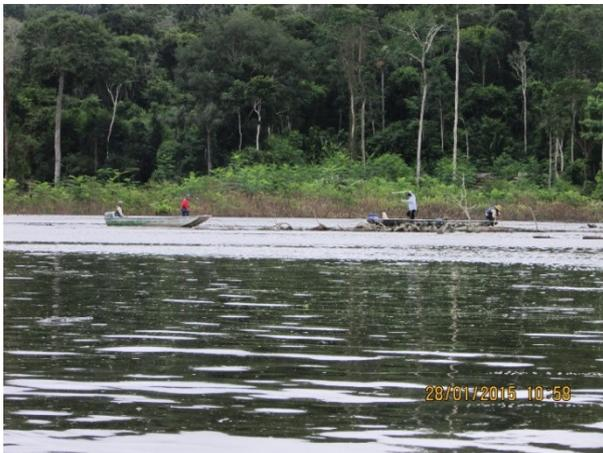
Foto 01. Barco adaptado com tora para empurrar material flutuante.
