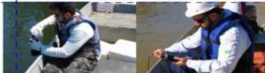
Nas fases de enchimento e pós-enchimento do reservatório da UHE Teles Pires será realizado o monitoramento da qualidade da água nos Rios Paranaíba e Teles Pires, com o objetivo de acompanhar os parâmetros físicos da água durante o processo de enchimento, sobretudo do oxigênio dissolvido na água que é essencial à vida aquática.
