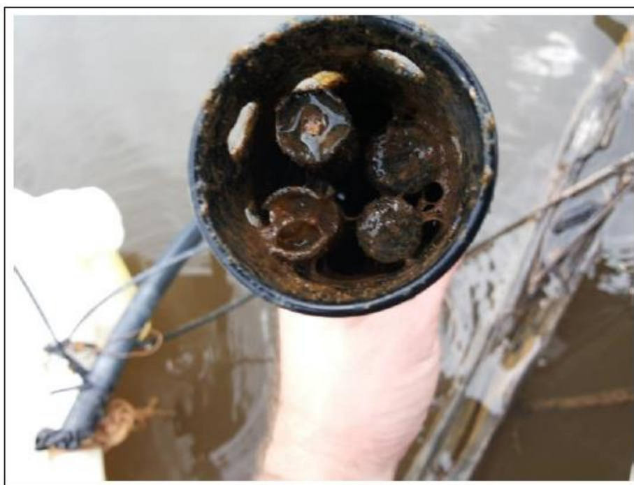
Figura 6. Incrustações nos sensores da sonda instalada no rio Paranaíta, em vistoria realizada no dia 22 de dezembro de 2014. Ressalta-se que em vistoria realizada no início do mês de dezembro realizou-se a limpeza dos sensores, sendo que o acúmulo anormal de incrustações ocorreu em um período muito curto de tempo.
