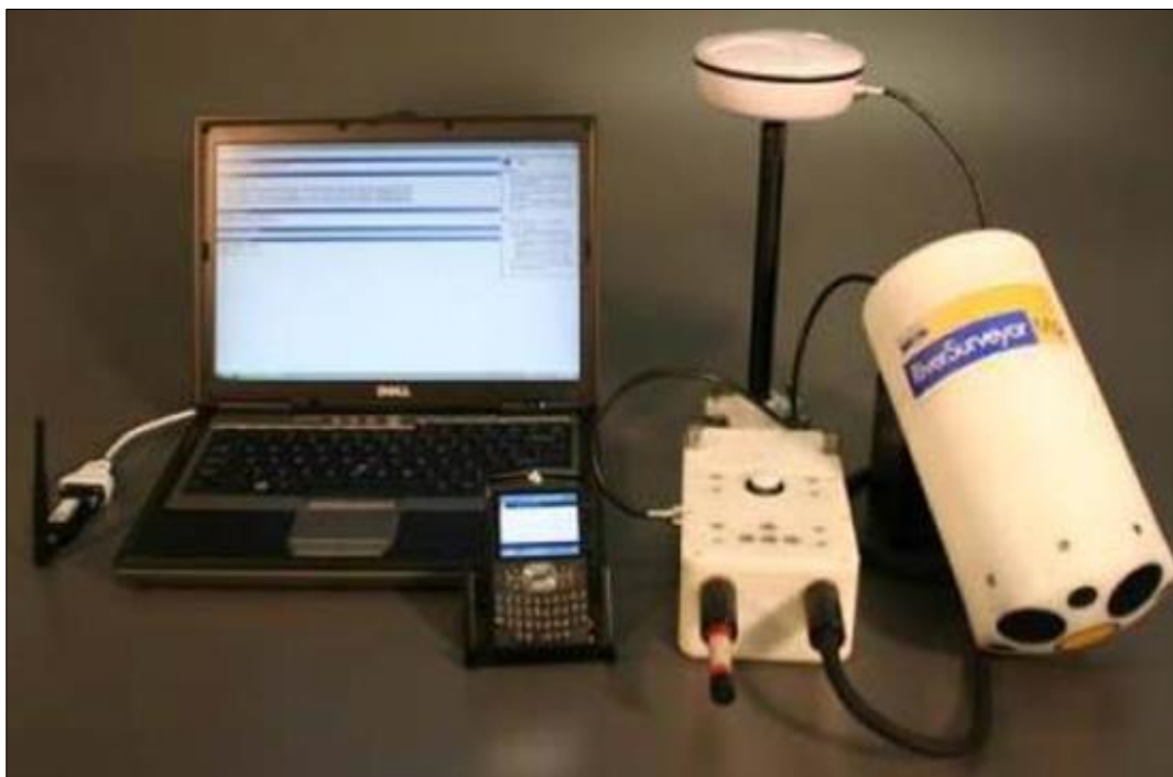
Figura 6. Hardware montado para a opção D-GPS com comunicações Bluetooth .
