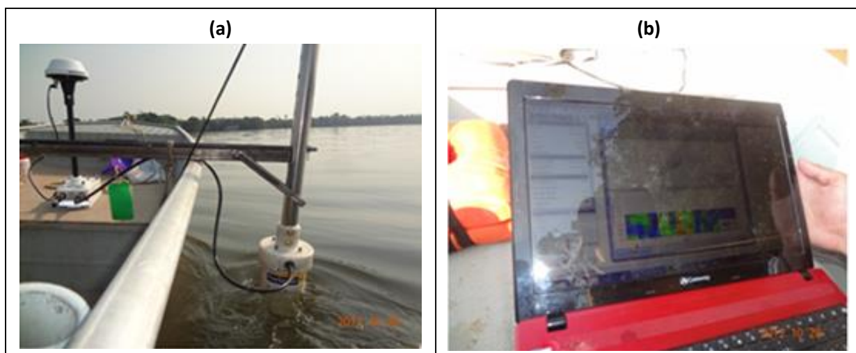
Figura 7. Medição de vazão com utilização do ADCP. (a) ADCP parcialmente submerso coletando dados; (b) notebook usado na visualização dos dados gerados e na orientação da velocidade de trânsito do barco durante a medição.
