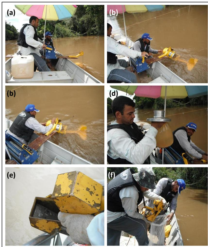
**Figura 7.** Amostragem da mistura água-sedimento utilizando o amostrador Saca AMS-8 (a, b, c, d) e amostragem do material de leito com a Draga Petersen (e, f).
