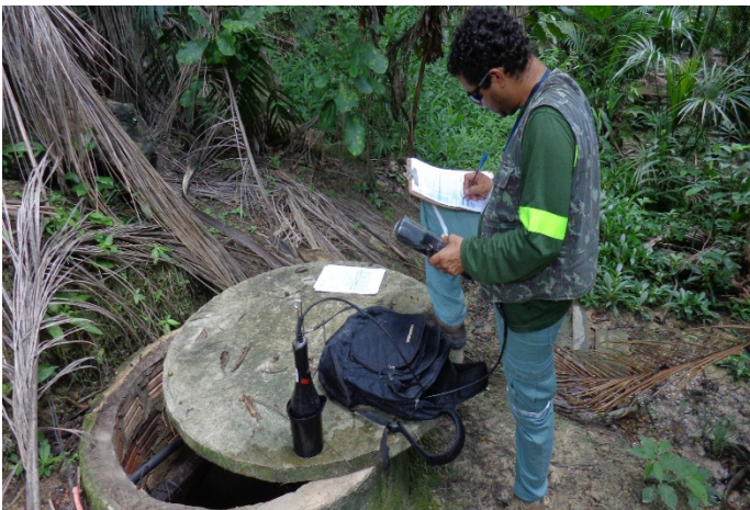
Figura 1 - Poço de Monitoramento 01 (PM 01) – Retirada de água e medição de nível no poço
