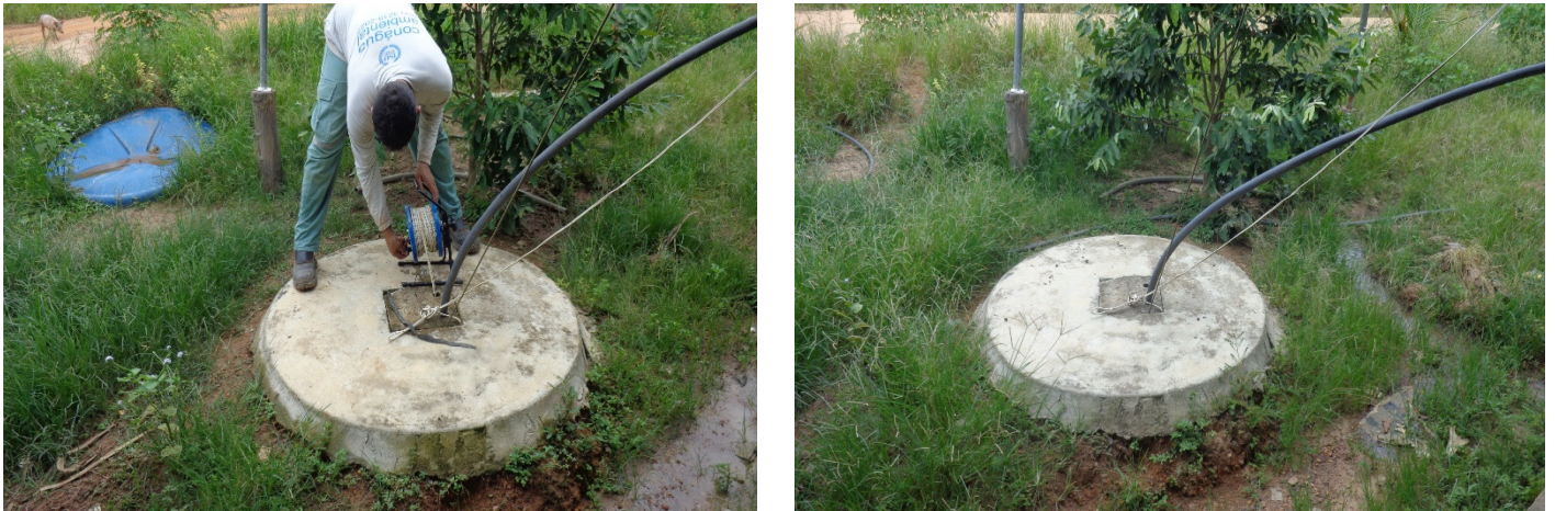
Figura 4 - Poço de Monitoramento 04 (PM 04) – Medição do nível d'água
