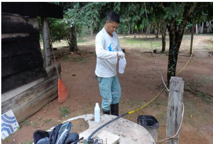
Figura 2 - Poço de Monitoramento 02 (PM 02) – Retirada da água da mangueira no poço
