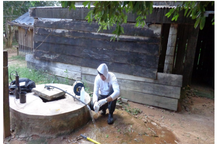
Figura 2 - Poço de Monitoramento 02 (PM 02) – Retirada da água da mangueira no poço
