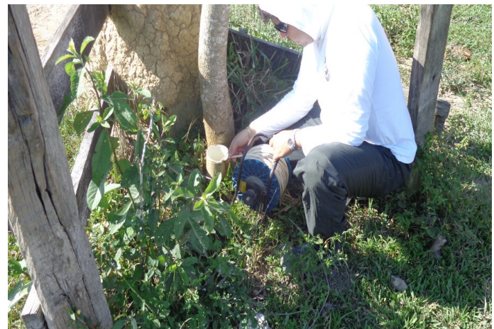
Figura 3 - Poço de Monitoramento 03 (PM 03) – Medição dos parâmetros in loco com sonda
