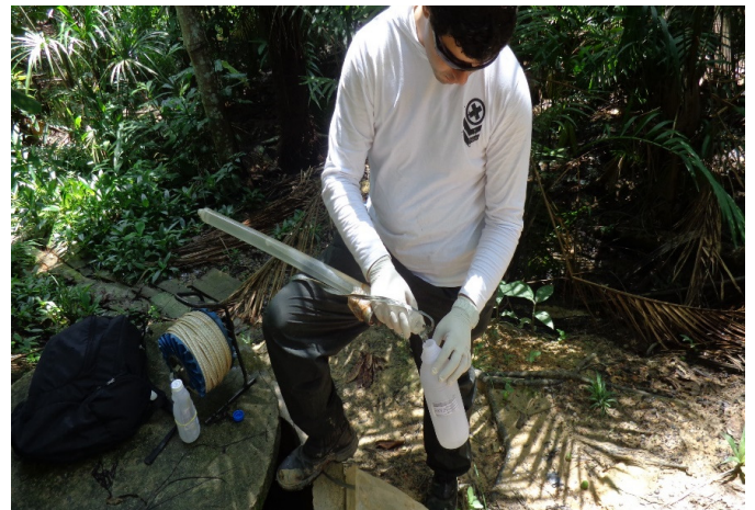
Figura 1 - Poço de Monitoramento 01 (PM 01) – Retirada de água e medição de nível no poço
