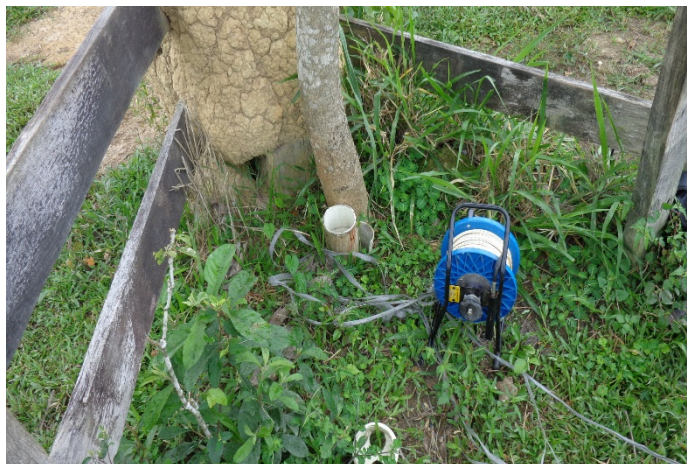
Figura 3 - Poço de Monitoramento 03 (PM 03) – Medição dos parâmetros in loco com sonda
