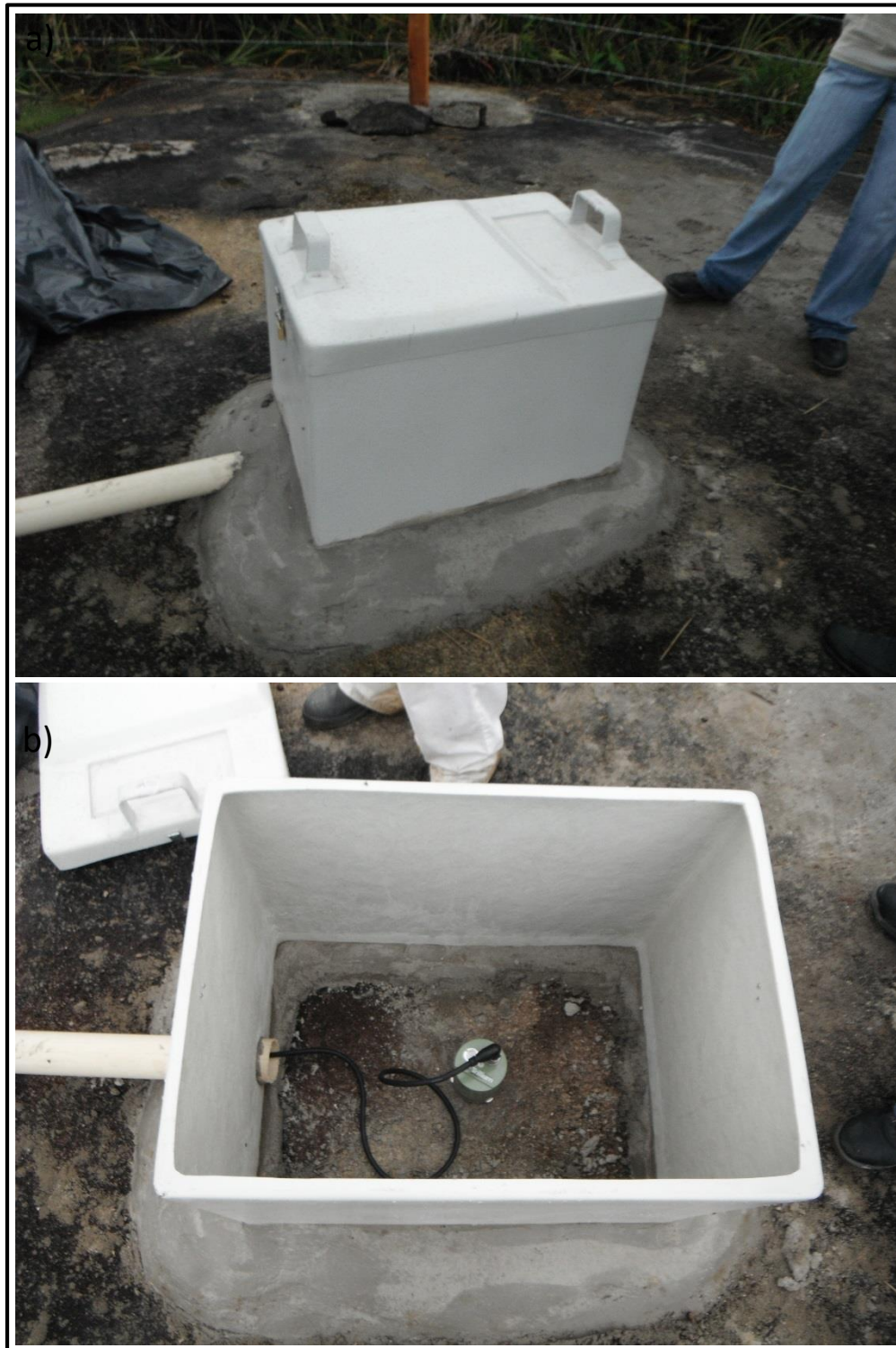
Figura 4 – Estação Sismográfica UHE Teles Pires 1 (STP1) na Fazenda Candinho, próxima ao rio Teles Pires. a) vista geral do abrigo do sensor (sismômetro). b) vista interna do abrigo do sensor com o sismômetro já instalado. O sensor deve sempre estar nivelado com o chão (isso é feito com o auxílio de uma bolha) e direcionado para o Norte, sendo que a direção do Norte deve ser obrigatoriamente corrigida com dados de sismos distantes.
