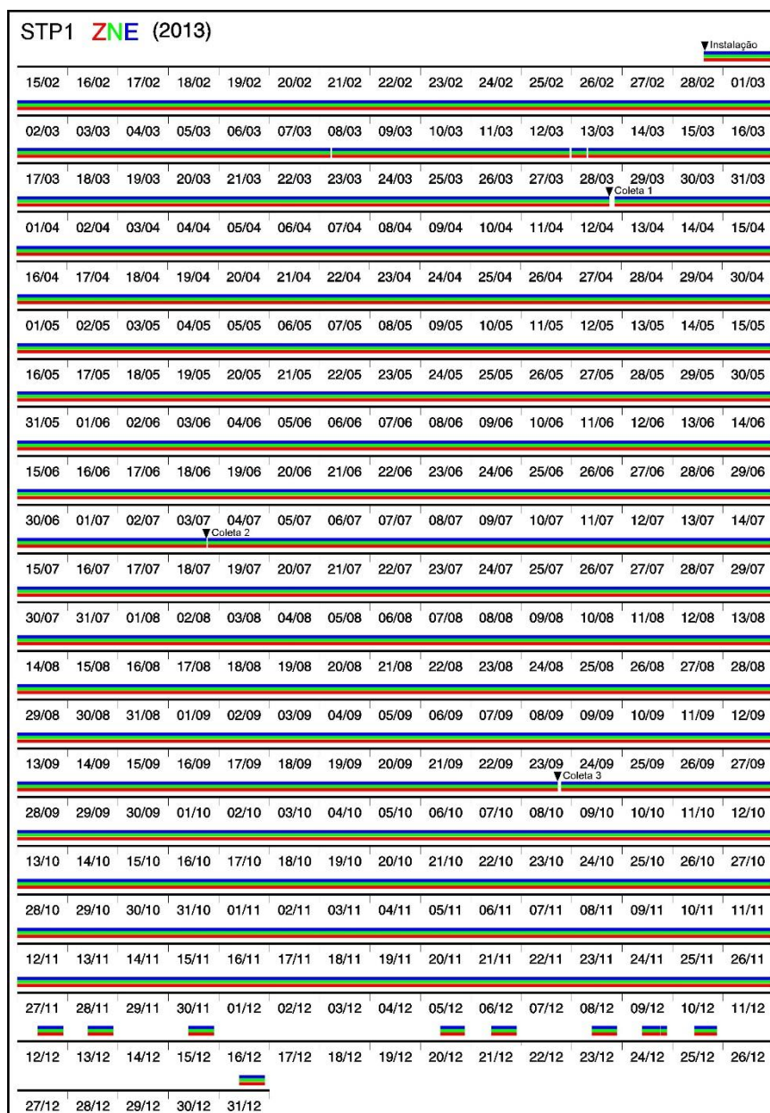
Figura 8 - Gráficos de funcionamento da estação STP1 com destaque em cores para o funcionamento de cada componente da estação (Vertical em vermelho, Norte-Sul em verde, e Leste-Oeste em azul). Os números abaixo dos traços representam o dia e o mês de funcionamento.
