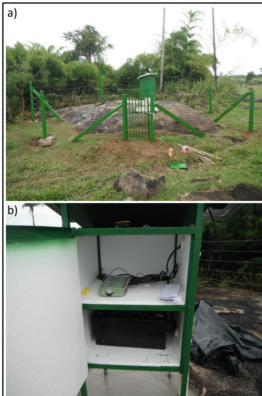
Figura 2 – Estação Sismográfica UHE Teles Pires 1 (STP1) na Fazenda Candinho, próxima ao rio Teles Pires. a) vista geral da estação e da cerca de proteção. b) vista do interior do abrigo do registrador, revestido com isopor para isolamento térmica parcial. Na prateleira de cima se encontra o registrador (peça verde) e o GPS, e na prateleira de baixo a bateria da estação, a qual é recarregada por um painel solar que se encontra sobre o abrigo do registrador.
