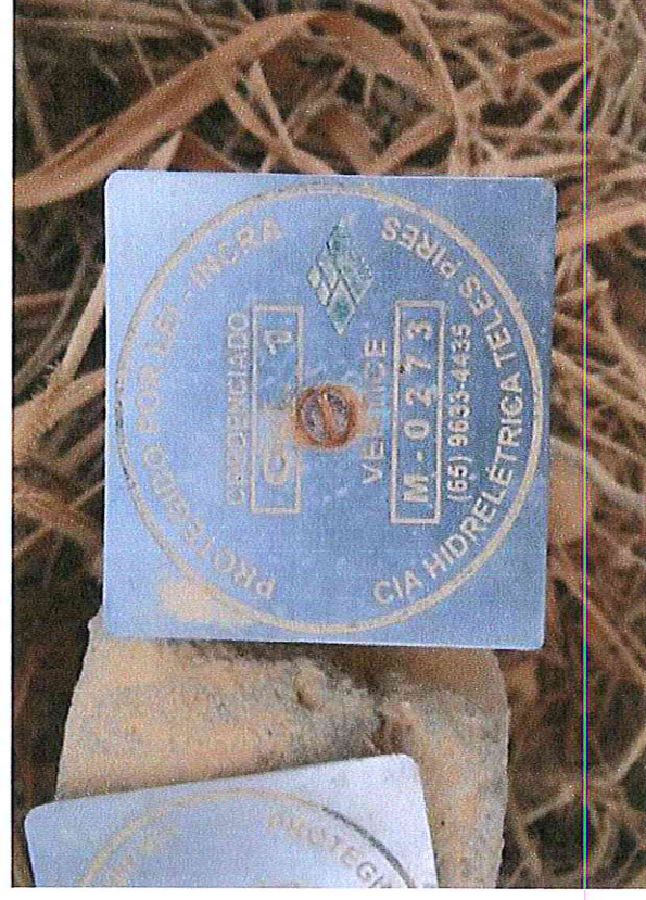
Marco de ferro galvanizado com plaqueta de identificação de vértices, de acordo com as Normas Técnicas do INCRA
