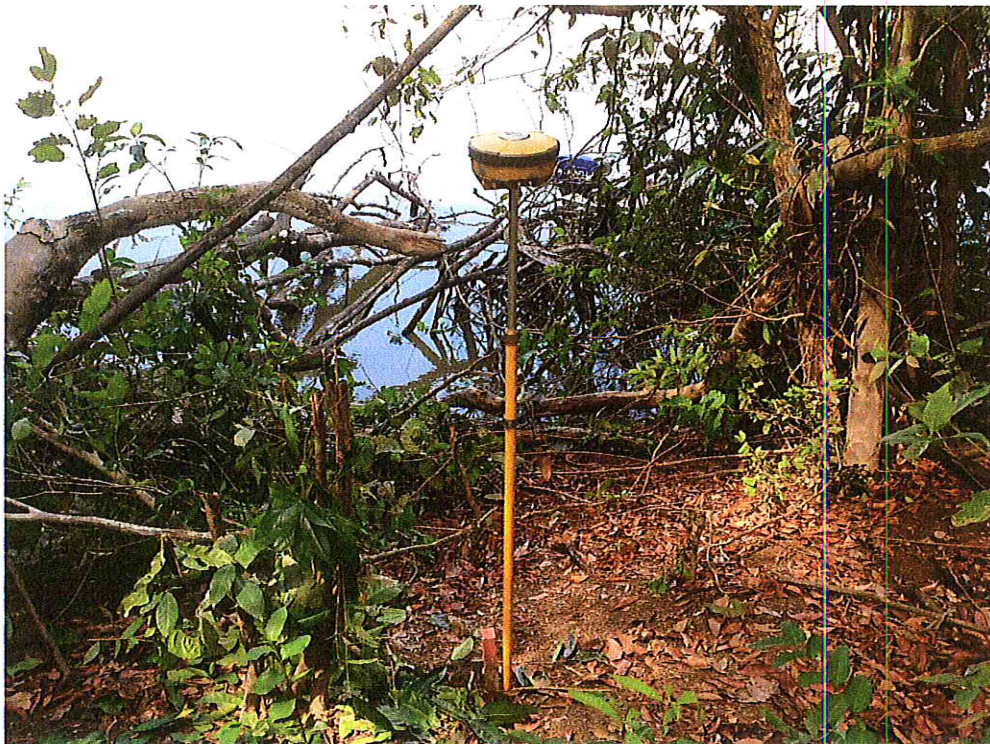
Foto 6 - Cota do N.A. 220,44 m, próximo do leito natural do rio Teles Pires em período de seca.
