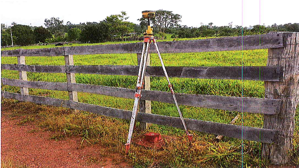
Figura 6 - GPS de Controle de Altitude e Coordenadas (Base), instalada no RN OE-074.
