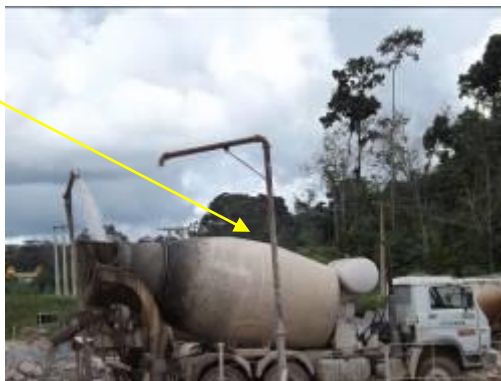
Processo de lavagem do balão da betoneira, aonde a água, ao chegar à segunda lagoa de decantação, é bombeado novamente para o início do processo, assim é feito o reuso da água.
