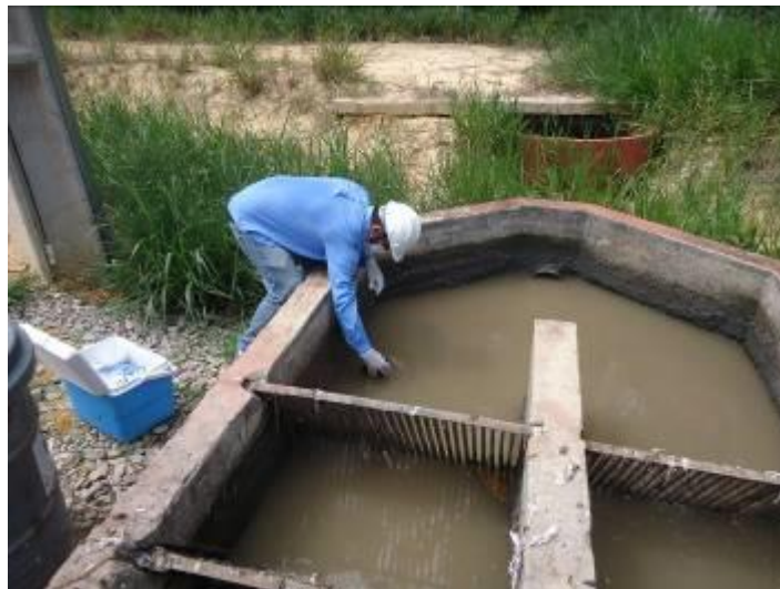
Coleta de amostras na ETE – 1 caixa de dessarenação entrada para o tratamento
