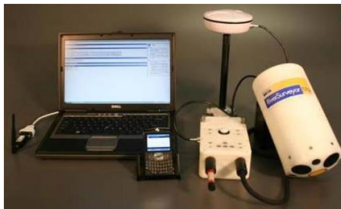
Figura 3. Hardware montado para a opção DGPS com comunicações Bluetooth.
