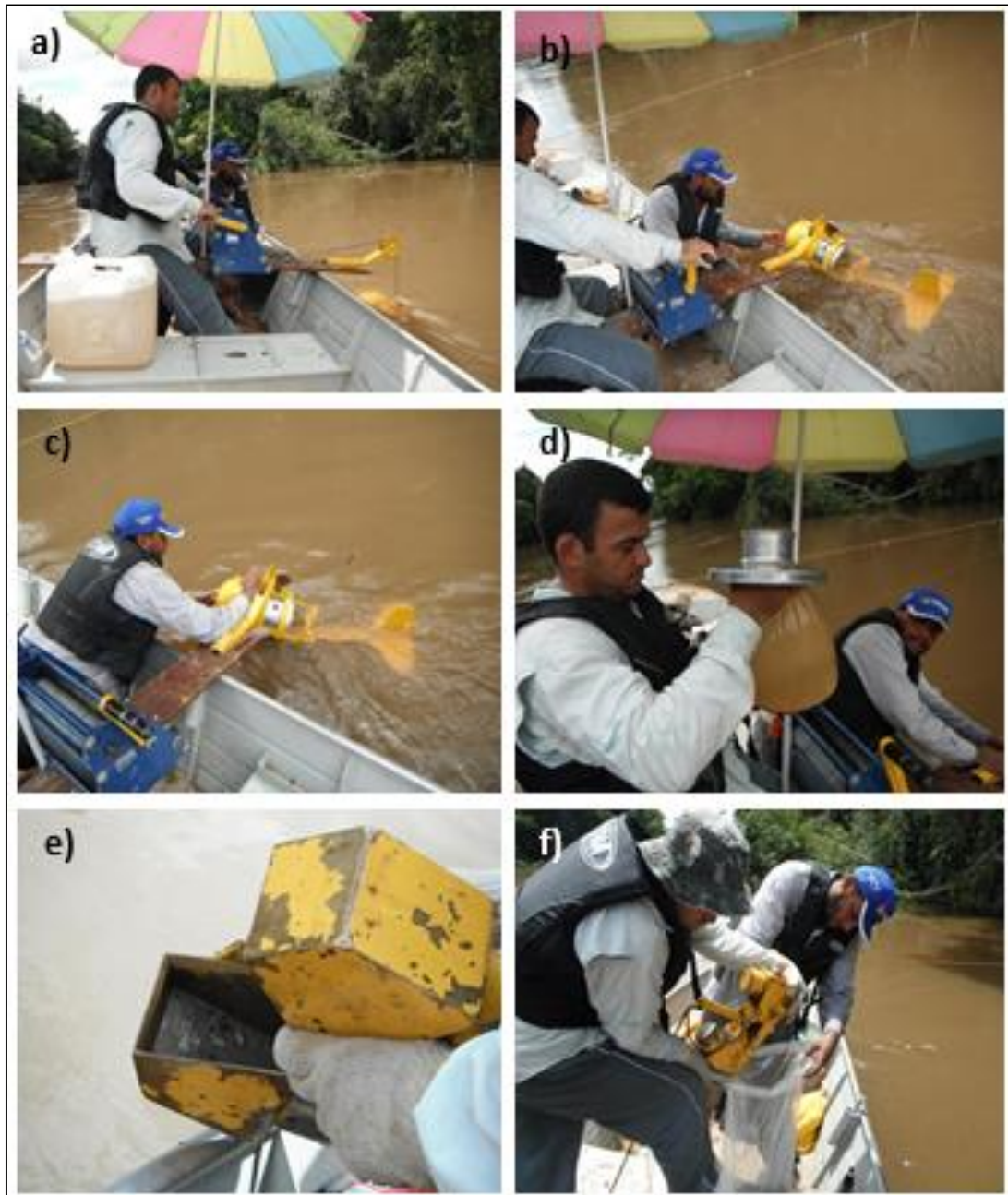
Figura 5. Amostragem da mistura água-sedimento utilizando o amostrador Saca AMS-8 (a, b, c, d) e amostragem do material de leito com a Draga Petersen (e, f).
