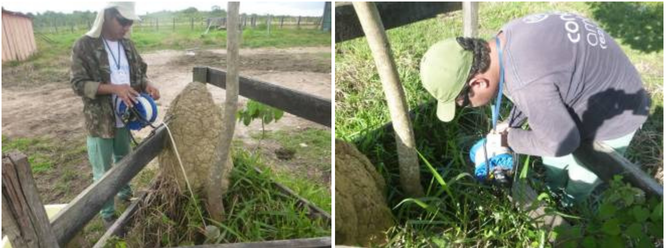
Figura 3 - Poço de Monitoramento 03 (PM 03) – Medição dos parâmetros in loco com sonda
