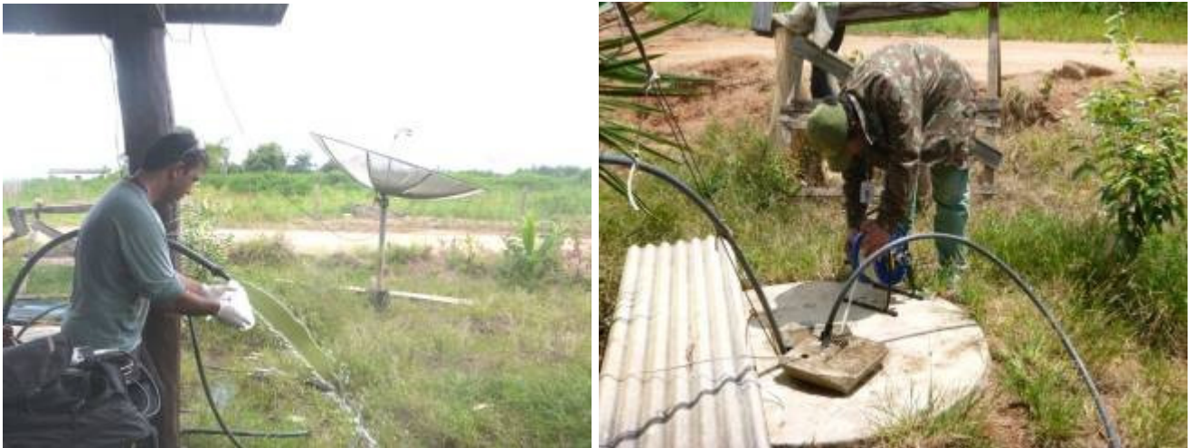
Figura 4 - Poço de Monitoramento 04 (PM 04) – Medição do nível d'água
