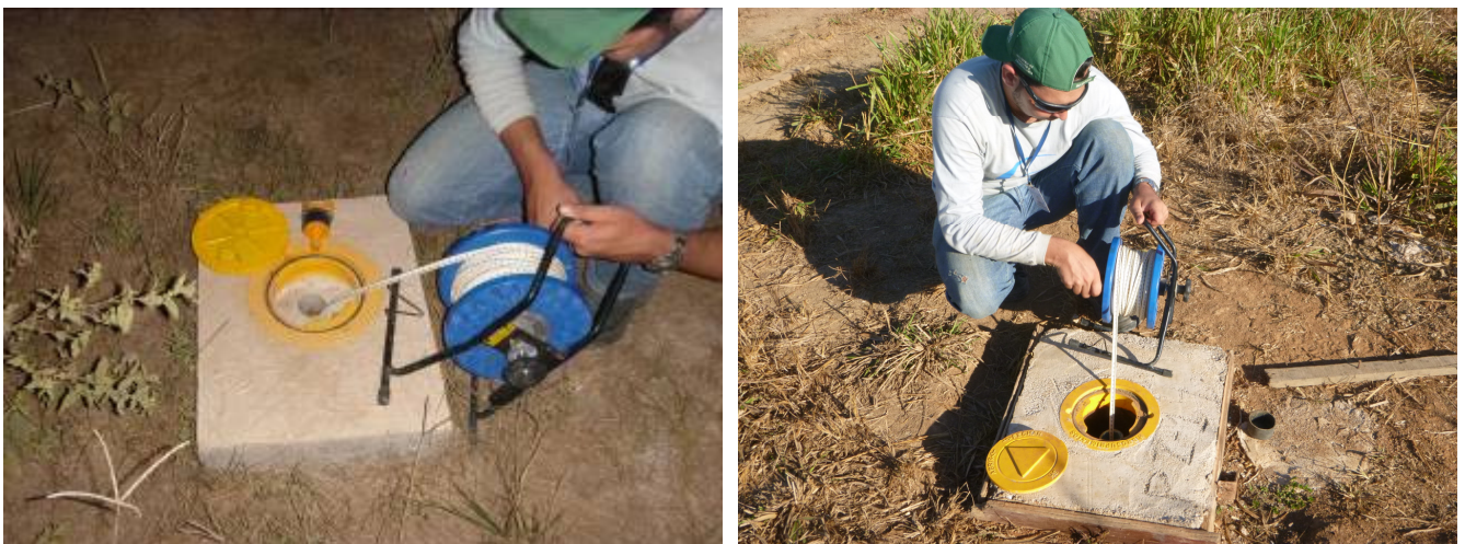
Figura 10 - Registro das leituras de nível realizadas no PZ06
