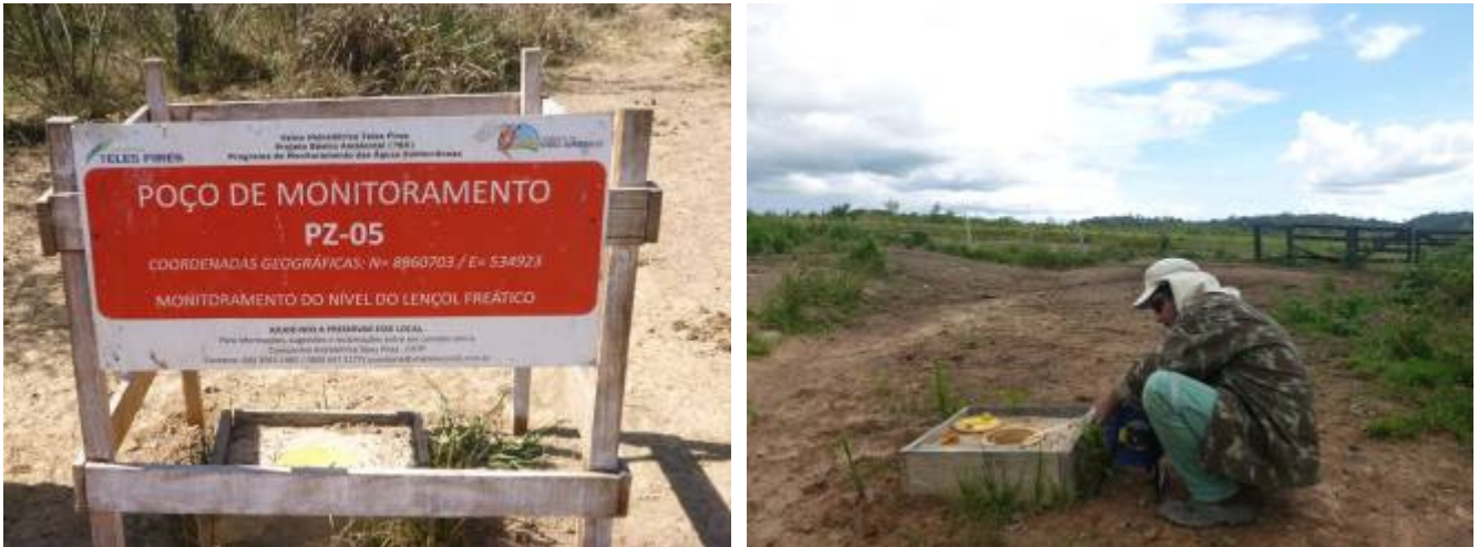
Figura 9 - Registro das leituras de nível realizadas no PZ05
