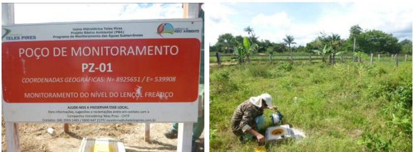
Figura 5 – Registro das leituras de nível realizadas no PZ01
