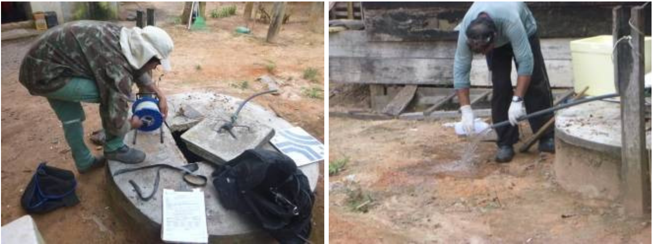
Figura 2 - Poço de Monitoramento 02 (PM 02) – Retirada da água da mangueira no poço
