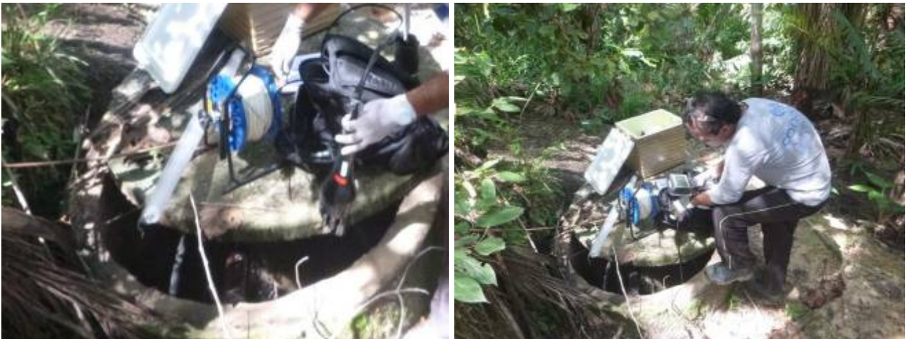
Figura 1 - Poço de Monitoramento 01 (PM 01) – Retirada de água e medição de nível no poço
