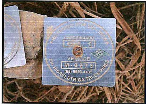
Marco de ferro galvanizado com plaqueta de identificação de vértices de acordo com as Normas Técnicas do INCRA.
