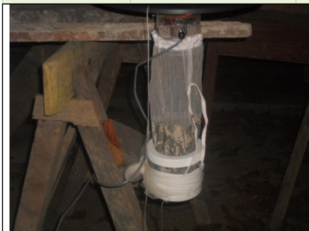
Foto 27 – Instalação de Armadilha CDC
