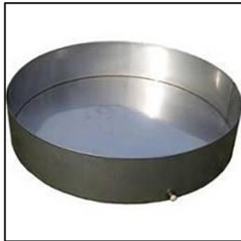
**Figura 11.** Painel (tanque) de evaporação Classe A.
