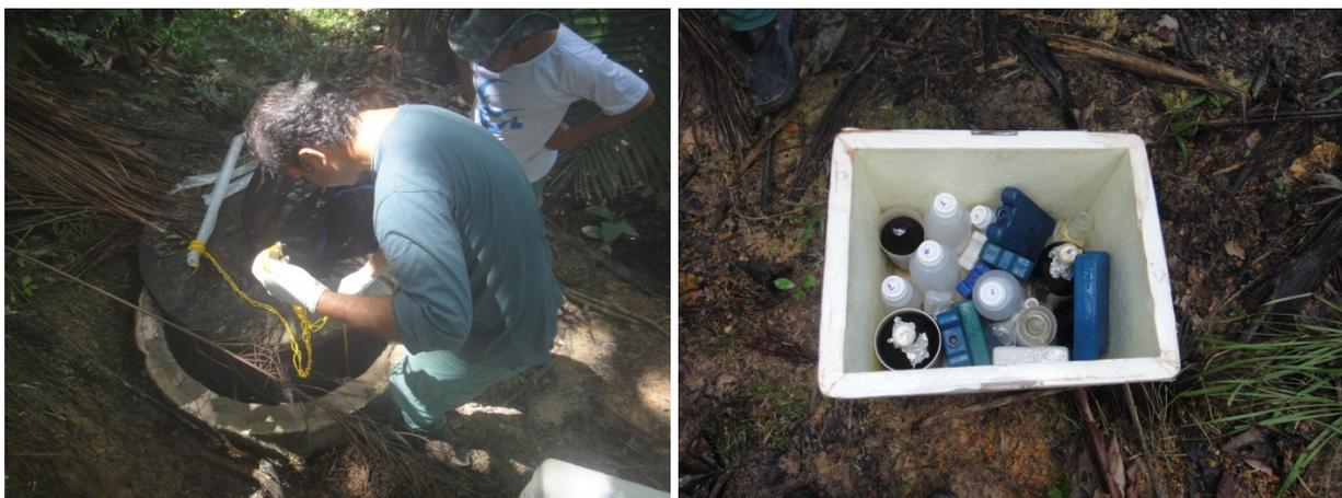
**Figura 1 - Poço de Monitoramento 01– (PM 01) - detalhes da coleta de água e frascos utilizados**
