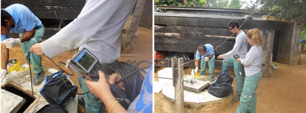
**Figura 2 - Poço de Monitoramento 02– (PM 02) - detalhes da coleta e medição dos parâmetros *in loco***
