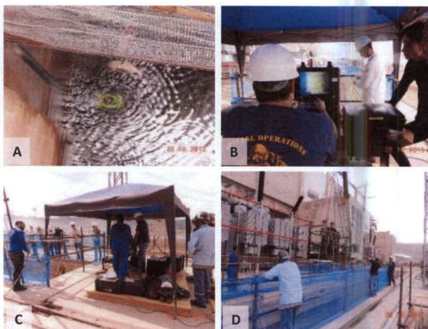
Prancha 15. A – Teste do ROV (Veículo Subaquático Operado Remotamente); na UG 04; B – Acompanhamento das imagens geradas pelo ROV. C – Acompanhamento durante os testes do ROV; D – mergulhadores auxiliando o uso do ROV.
