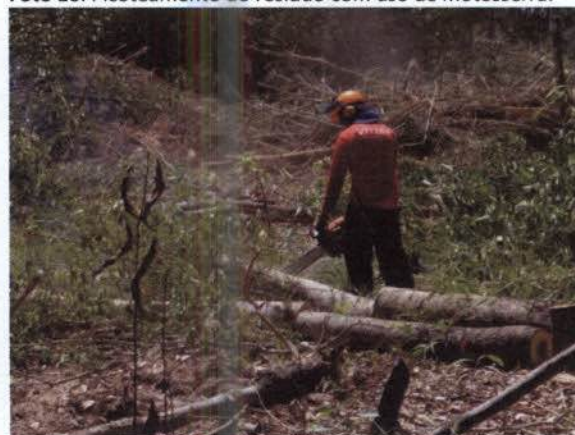
Foto 18. Redimensionamento do fuste com motosserra.
