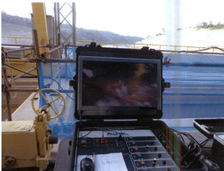
Figura 9 – Equipamento de comunicação audiovisual entre os mergulhadores e a equipe de superfície.
