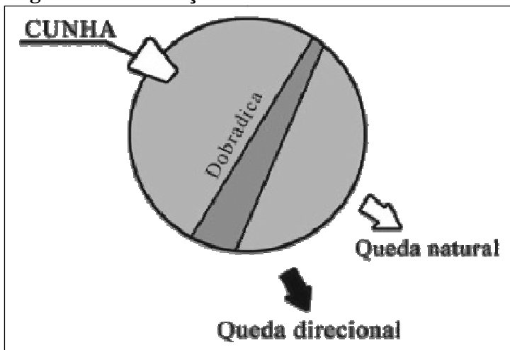
Figura 5 Redirecionamento da queda da árvore através da adoção de cunha e assimetria na largura da dobradiça
