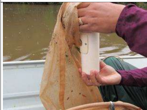
Foto 03: Retirando amostra de ictioplâncton do copo armazenador.
