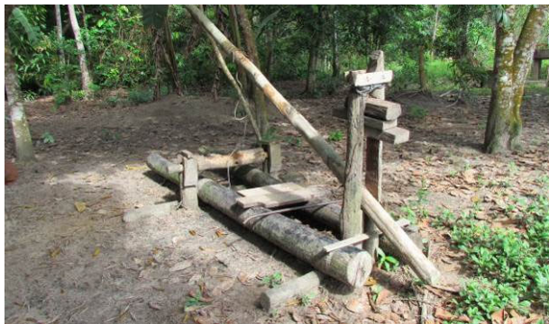
Foto 33 Detalhe da prensa de mandioca com cabo de aço (aldeia Vila Nova, 19/11/14).
