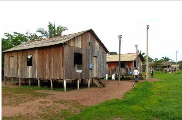
Foto 15: Detalhe de residências na aldeia Taboka (09/11/14), construídas com tábuas serradas e com cobertura de palha de babaçu ( Attalea speciosa ) e telhas de fibrocimento onduladas.
