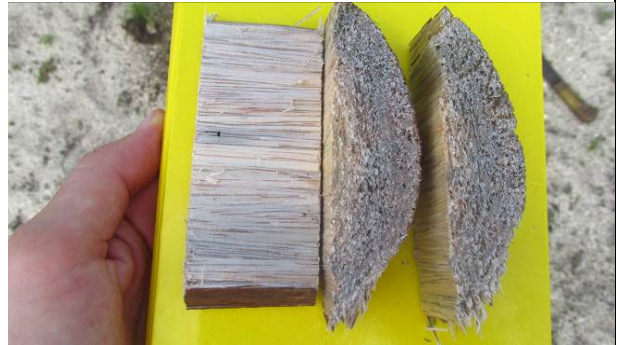
Foto 64: Detalhe de descartes de madeira, serrada com auxílio de moto-serra, para encaixe das vigas, caibro e esteio.
