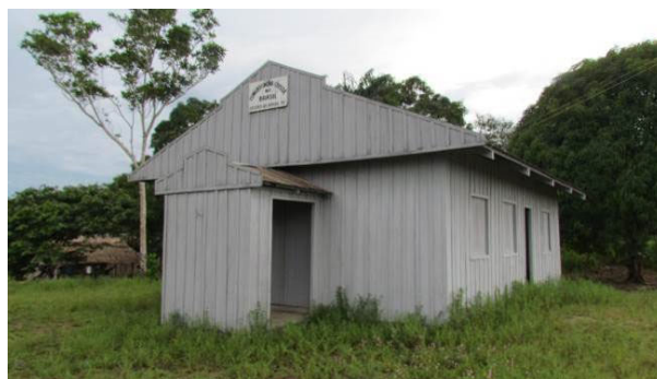
Foto 46: Detalhe de igreja na aldeia Marmelos 1 (18/11/14), toda construída com tábuas serradas e com cobertura de telhas de fibrocimento onduladas.
