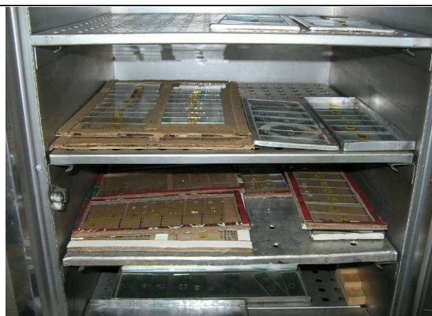
Foto 22: Laboratórios de Entomologia em Saúde Pública, Faculdade de Saúde Pública da USP. Secagem de lâminas contendo montagens de mosquitos – genitálias masculinas de mosquitos adultos e exúvias de larvas e pupas de imaturos. O material permanece em estufa por alguns dias até o bálamo secar e as lâminas poderem ser examinadas na microscopia. Ilustração obtida na 1ª Campanha.
