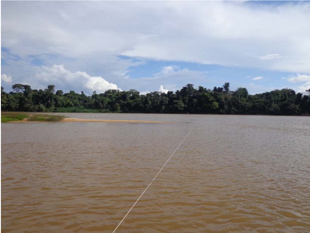
Figura 15 – Corda graduada ligando as duas margens da Seção 3.
