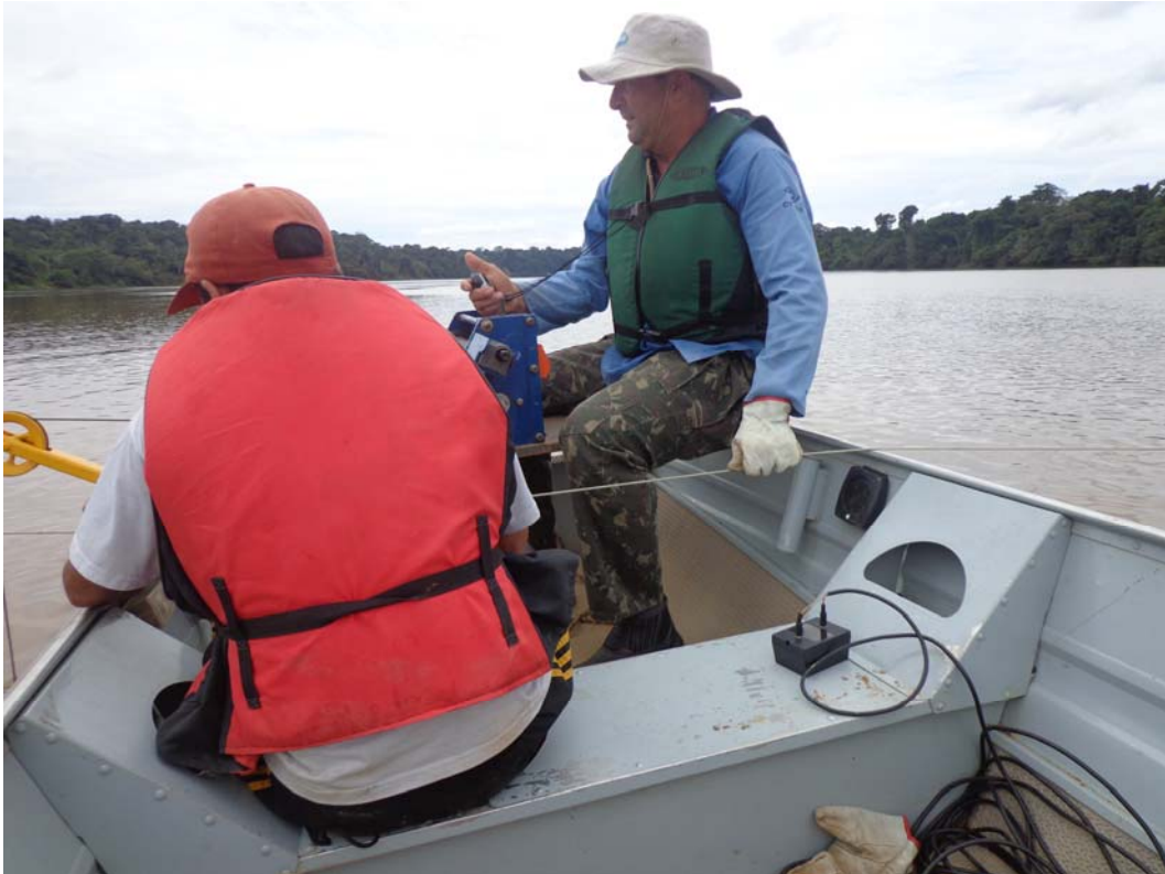
Figura 17 – Medição da velocidade utilizando o guincho hidrométrico e o molinete (Seção 3).
