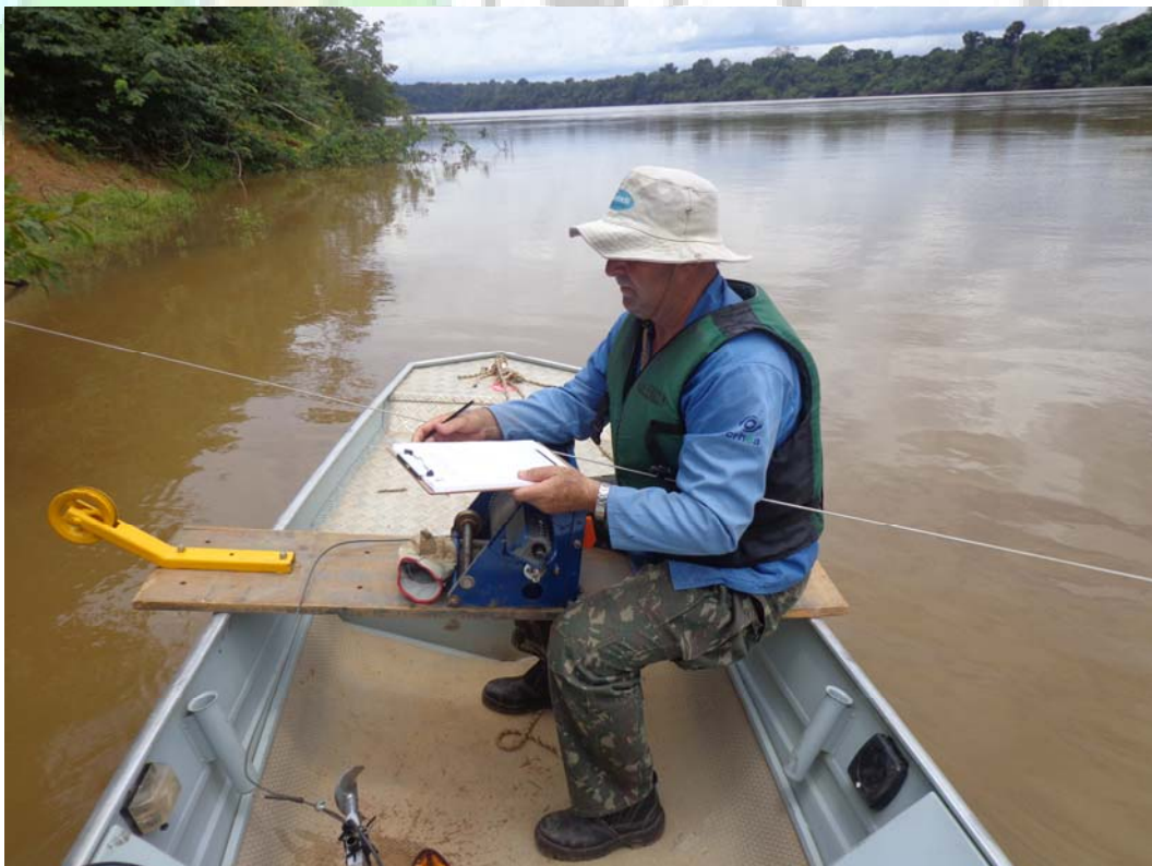
Figura 16 – Medição da profundidade utilizando o guincho hidrométrico (Seção 2).
