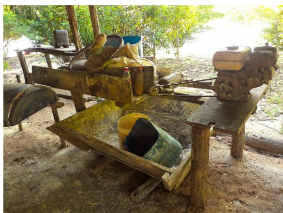
Foto 29. "Caititu" e motor à gasolina utilizada para ralar a mandioca.
