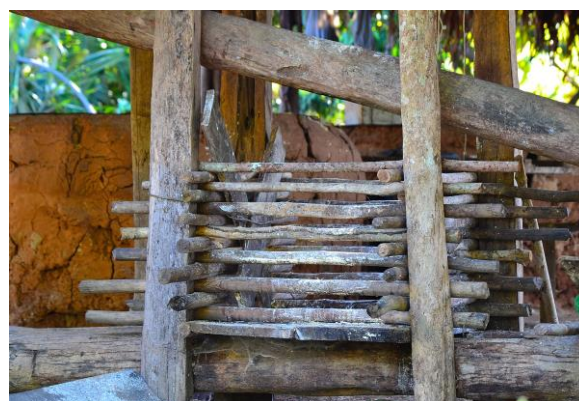
Foto 24. Armação de madeira utilizada como prensa na retira do sumo venenoso (ácido hidrocianico) da massa da mandioca.
