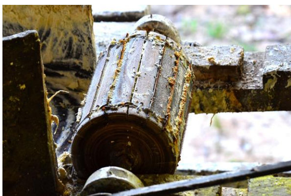
Foto 23. Detalhe de ralador à motor conhecido como “caititu”.
