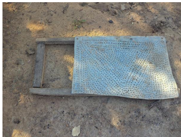
Foto 26. Ralador feito de chapa de metal e madeira que era utilizado antes da obtenção do ralador a motor.
