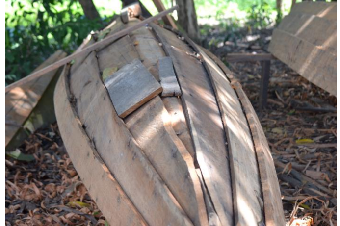
Foto 03. Canoas feitas a partir da sobreposição de tábuas.
