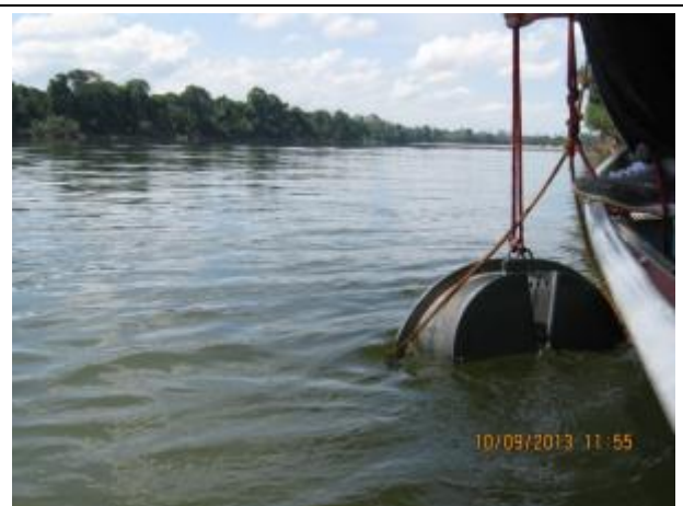
Foto 12: Coleta de macroinvertebrados bentônicos realizada com a Draga de Van-Veen.
