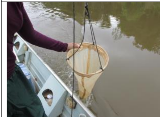
Foto 03: Rede utilizada na coleta qualitativa de fitoplâncton (20µm de malha).
