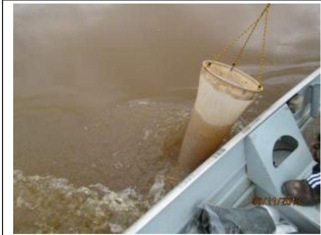
Foto 07: Rede utilizada na coleta qualitativa de zooplâncton (50µm de malha).
