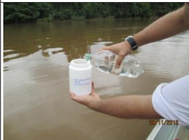
Foto 15: As amostras de macroinvertebrados bentônicos foram fixadas com formol a 4%.
