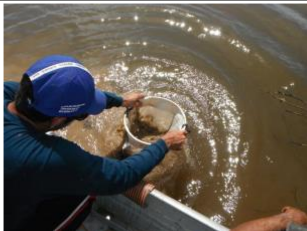
Foto 13: Lavagem do material coletado com a draga em peneira com 250 micra de abertura de malha.
