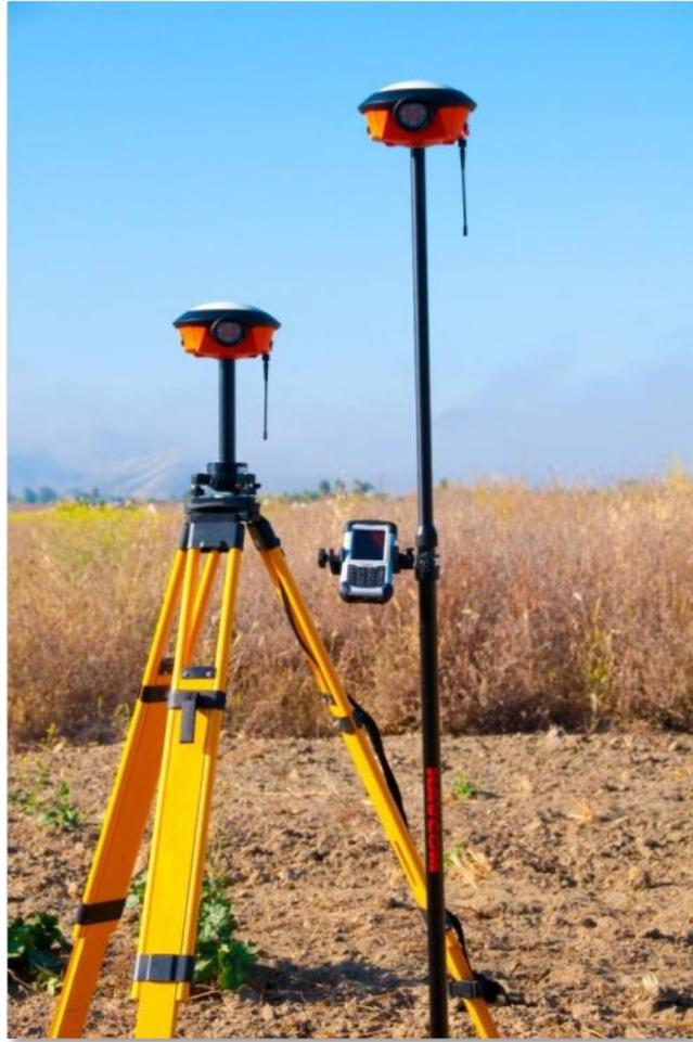
**Figura 2 - GPS receptor GNSS NavCom SF 3040. Fonte: Manual Técnico Land-Pak NavCom Technology.**
