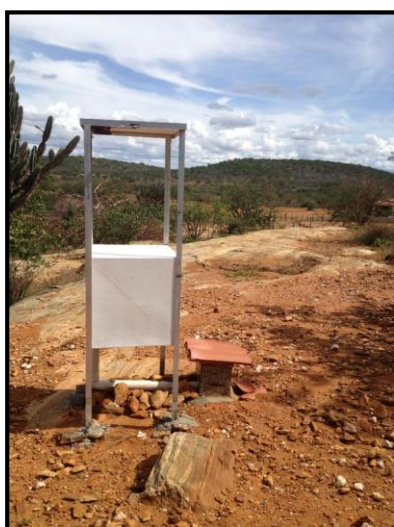
Figura 34: Instalação da nova estação sismográfica temporária em substituição da estação SOB 02 instalada anteriormente no município de Casa Nova/BA.
