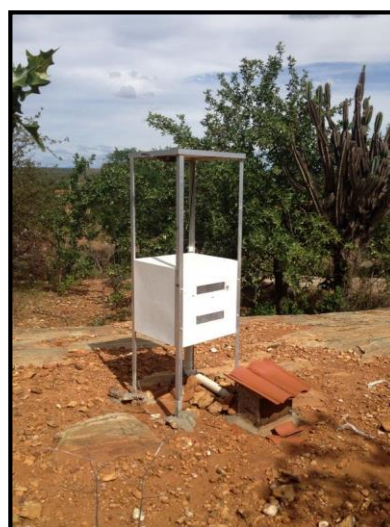
Figura 34: Instalação da nova estação sismográfica temporária em substituição da estação SOB 02 instalada anteriormente no município de Casa Nova/BA.
