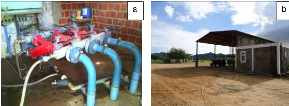
Figura 64 – a) Filtro de tela pertencente ao sistema de irrigação. b) Fazenda em Pau à Pique.
