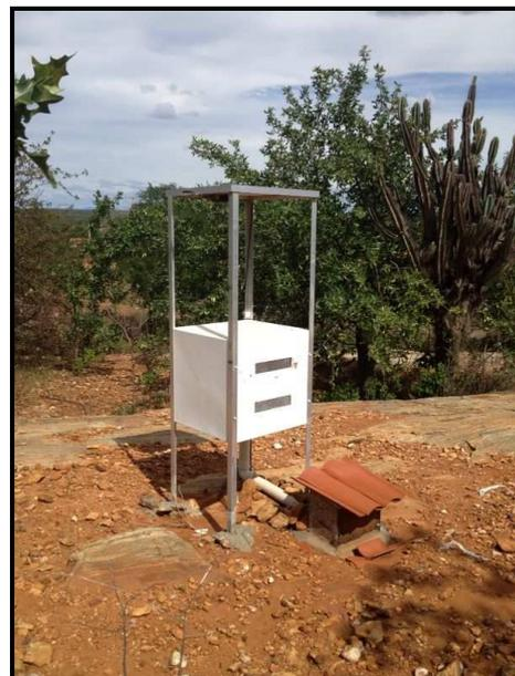
**Figura 29:** Instalação da nova estação sismográfica temporária em substituição da estação SOB 02.
