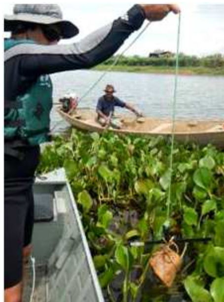
Figura 100: Garatêia adaptada para coleta de macrófitas submersas
