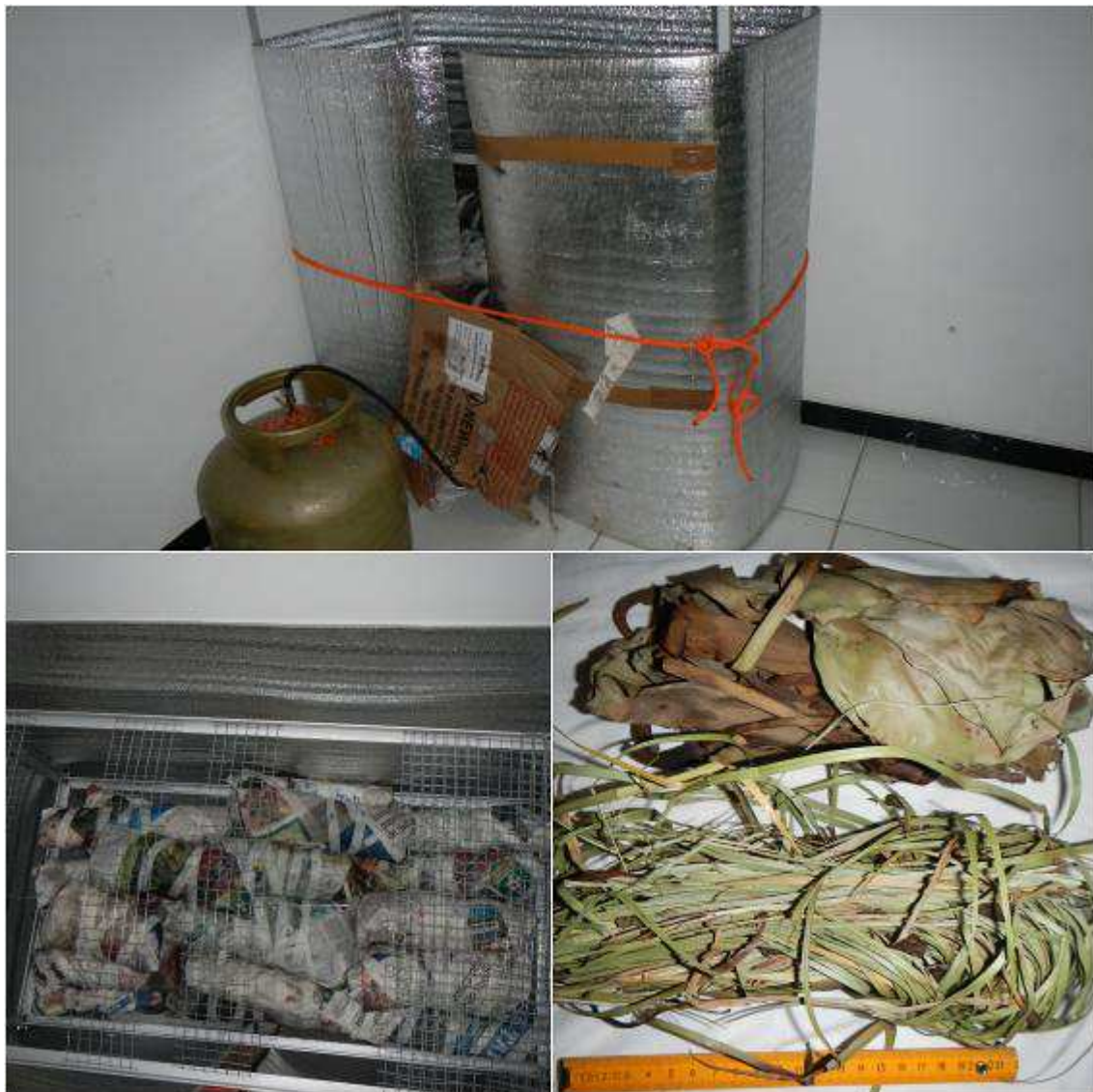
Figura 113. Estufa de secagem a gás, em detalhe, frações de macrófitas embaladas em jornais e separadas por espécies.
