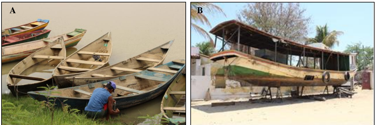
Foto 19: A - Canoa a remo (regata) recebendo manutenção do seu proprietário; B - Barco mãe construído em ferro, Remanso (Imagem Sérgio Albuquerque)
