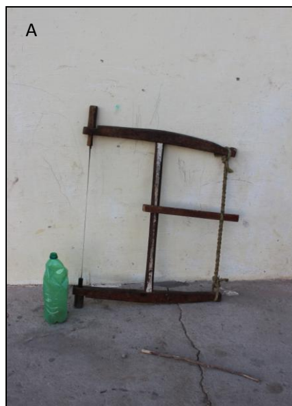
Foto 14: A – Arco de serra para realização de cortes com detalhes; e, B – Serrotão, manejado por dois homens para derrubar a árvore e os cortes mais brutos. Carpintaria localizada na comunidade de Passagem, Pilão Arcado (Imagem Sérgio Albuquerque).
