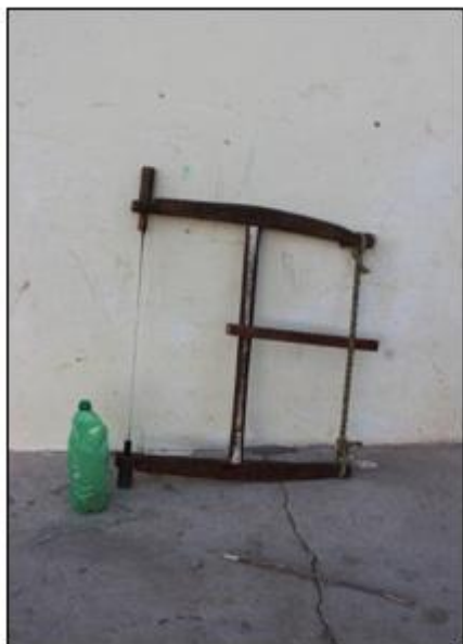
Foto 93: A – Arco de serra para realização de cortes com detalhes; e, B – Serrotão, manejado por dois homens para derrubar a árvore e os cortes mais brutos. Carpintaria localizada na comunidade de Passagem, Pilão Arcado (Imagem Sérgio Albuquerque).
