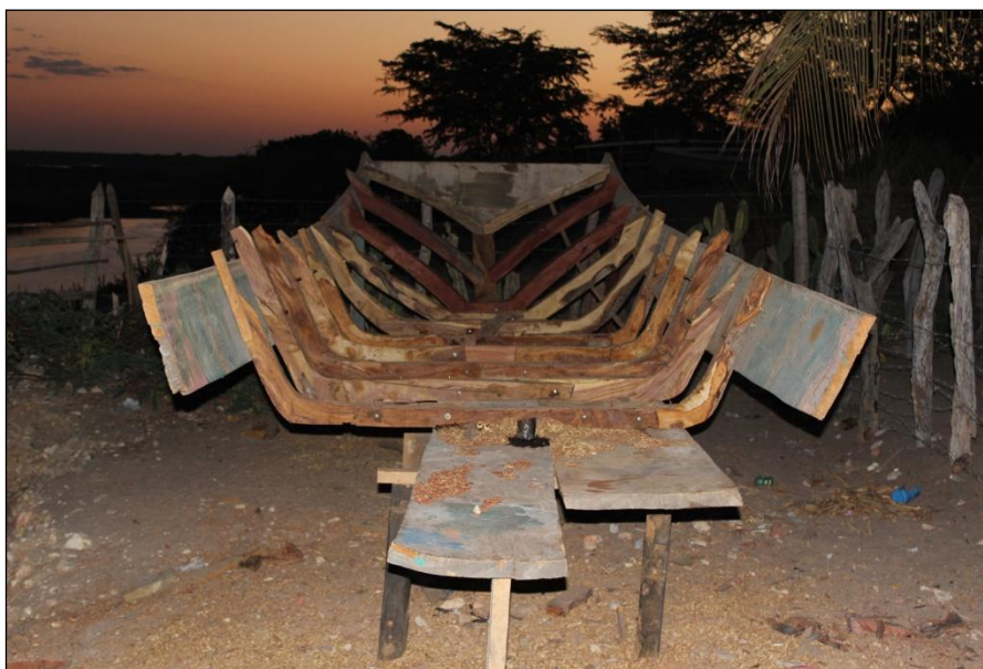
Foto 92: Estruturas de madeira chamadas de caverna, principal eixo de sustentação da embarcação. Comunidade de Passagem, Pilão Arcado (Imagem Sérgio Albuquerque)
