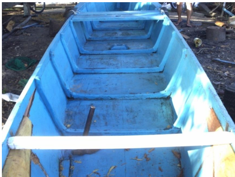
Figura 9.5 Barco com caverna e fundo fixado longitudinalmente. Foto: Ricardo Pereira, 2011.
