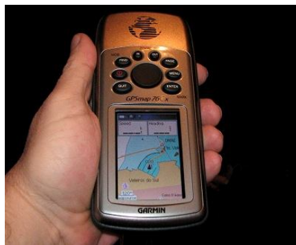
Figura 6.7 – GPS de Navegação Garmimmap76Sx utilizado na determinação das coordenadas de partida das estações de monitoramento.
