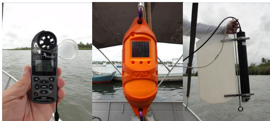
Figura 4.1 – Instrumentos empregados na mensuração de variáveis meteorológicas e hidrológicas: mini-estação Kestrel (esquerda), mini-CTD YSI CASTAway (meio) e correntômetro Aquadopp modelo AQD 5776 (direita).
