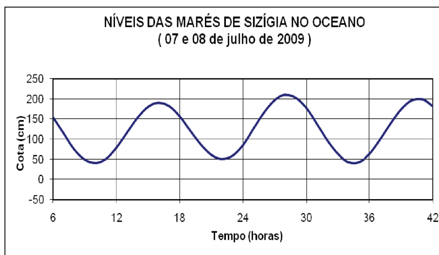
18 Figura 5.5.B-28 - Variação dos níveis da água durante as marés de Sizígia na foz do rio São Francisco, 19 das 06:00 horas do dia 07 até as 18:00 horas do dia 08 de julho de 2009. (Dados gerados a partir da Maré 20 prevista, para o porto de Maceió, pela DHN da Marinha do Brasil).
