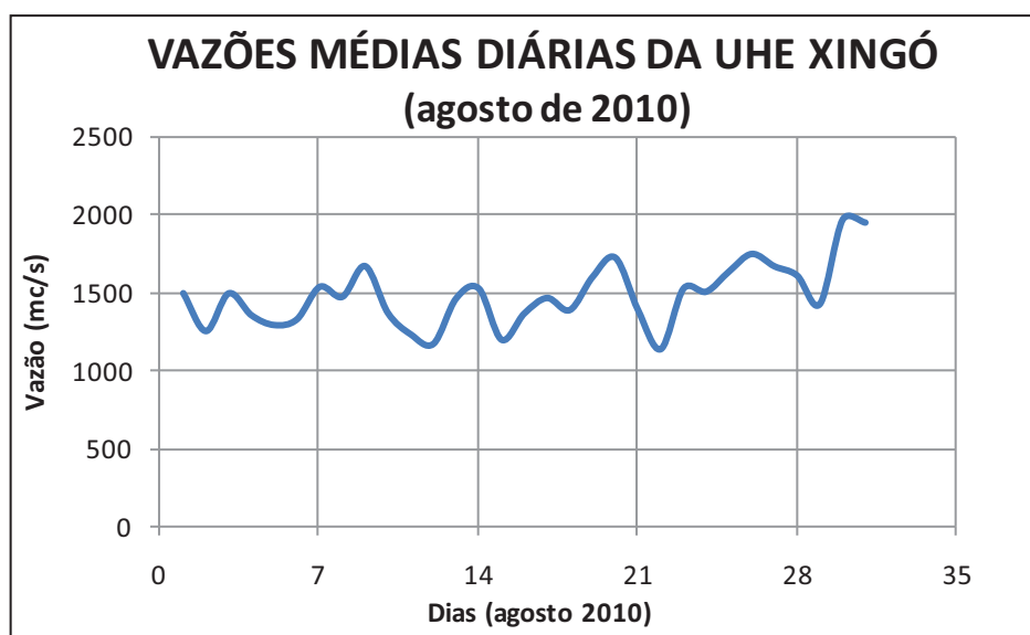
21 Figura 5.5.C-2 - Vazões médias diárias defluentes da Usina Hidroelétrica de Xingó no mês de agosto de 22 2010. Fonte: CHESF.
