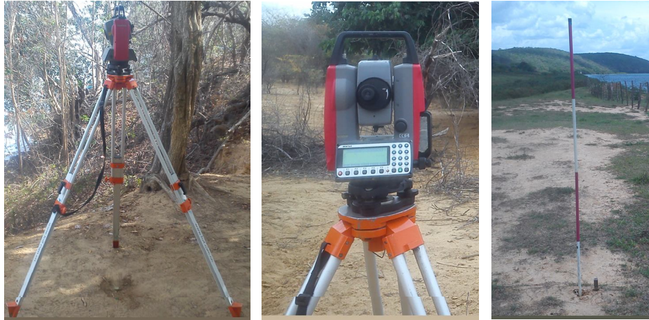
Figura 6.8 –Estação Total Pentax R425VN: utilizada na determinação do plano cotado e dos perfis, bem como nas leituras resultantes do levantamento planialtimétrico.
