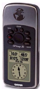
Figura 6.7 – GPS de Navegação Garmim map 76Sx utilizado na determinação das coordenadas de partida das estações de monitoramento.
