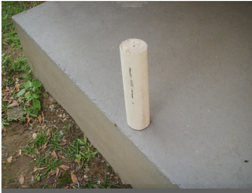
Figura 6.3 – Marcos de concreto utilizados na demarcação das áreas de monitoramento dos Processos Erosivos.
