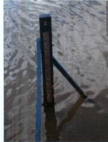
Foto 32: Régua de monitoramento do nível d'água no ponto de captação da CEDAE, RJ.
