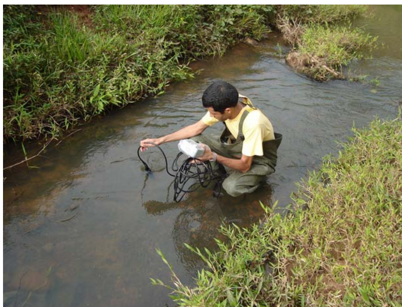
FIGURA 3.7 TOMADA DE PARAMETROS AMBIENTAIS COM O MULTISENSOR YSI-85 NO RIO MACUCO (SÍTIO 10)
