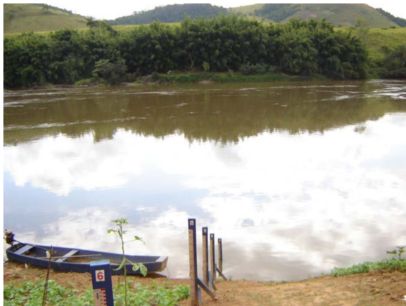
FIGURA 2.11 POSTO FLUVIOMÉTRICO SIMPLÍCIO “H” NO RIO PARAÍBA DO SUL – SEÇÃO DE MEDIÇÃO E CONJUNTO DE RÉGUAS (MARGEM DIREITA)
