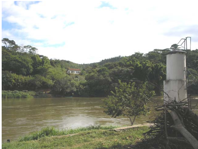
FIGURA 2.10 POSTO FLUVIOMÉTRICO ANTA “G” NO RIO PARAÍBA DO SUL – SEÇÃO DE MEDIÇÃO E LIMNÍGRAFO (MARGEM DIREITA)
