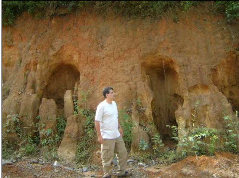
Figura 03 – Perfil típico de Latossolo Vermelho-Amarelo distrófico apresentando espessura elevada.
