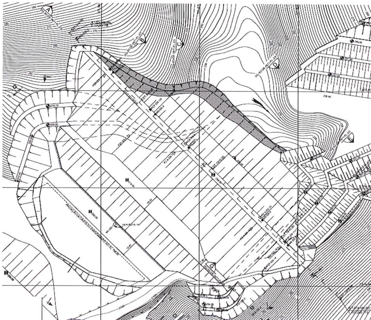
FIGURA 12 – Dique Sul – Planta
