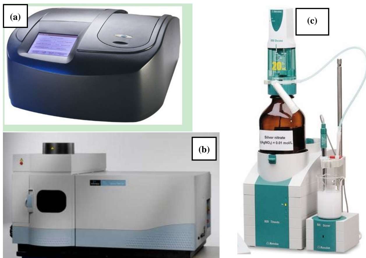
Figura 3-1 – Equipamentos do Laboratório de Química: (a) Espectrômetro Ultravioleta-Visível (nitrogênio, nitrato e sulfato), marca Hach, Modelo DR 5000, Alemanha. (b) Espectrômetro de Emissão Ótica em Plasma Induzido por Argônio – ICP-OES (metais), marca Perkin Elmer, modelo Optima 7300 DV, EUA. (c) Titulador automático (alcalinidade total e cloreto), Marca Metrohm, modelo Titrando 809, Suíça.
