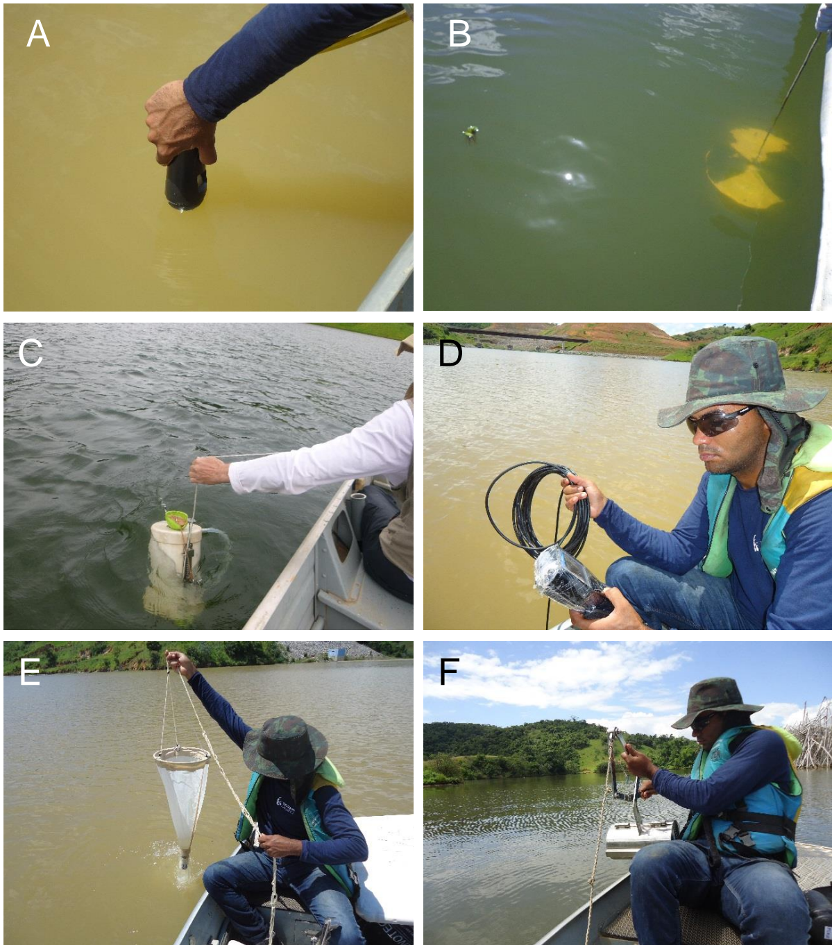
Figura 36. Registros fotográficos dos procedimentos de amostragem de campo na área de influência do AHE Simplício – Queda Única. A: profundímetro manual para determinação da profundidade; B: disco de Secchi para medida da transparência da água; C: garrafa de Van Dorn de 10 L de capacidade para coleta de amostras na coluna de água; D: sonda multi-paramétrica; E: rede de plâncton para coleta de fitoplâncton qualitativo e zooplâncton quantitativo; F: draga de aço inox tipo Petersen para coleta de sedimento para determinação da granulometria, análises físicas e químicas e identificação de macroinvertebrados bentônicos.
