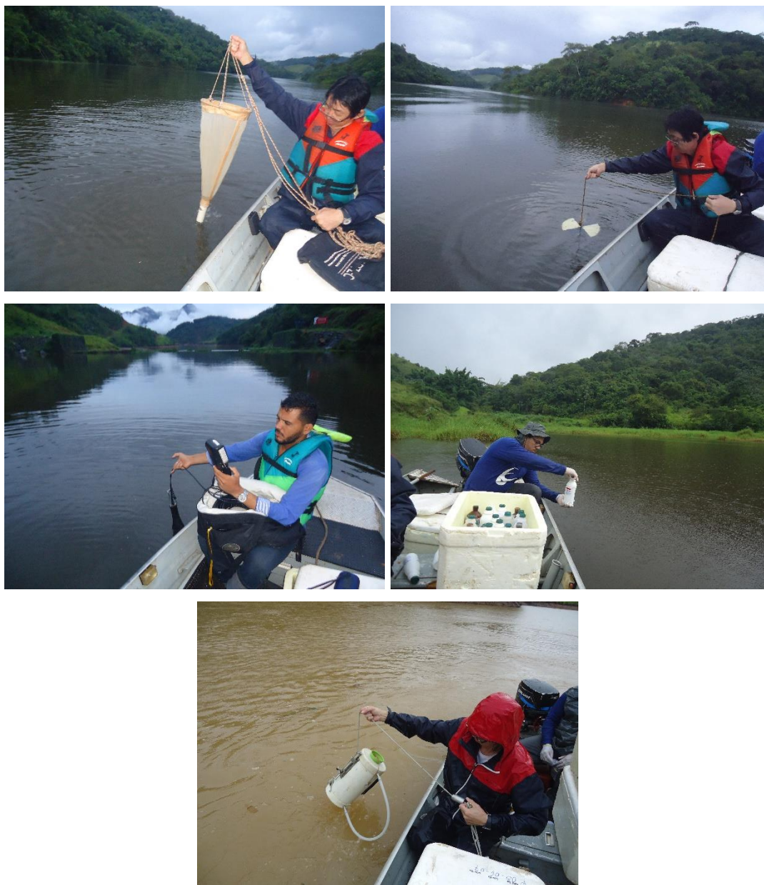
Figura 31. Coleta de amostras limnológicas na área de influência do AHE Simplício – Queda Única.
