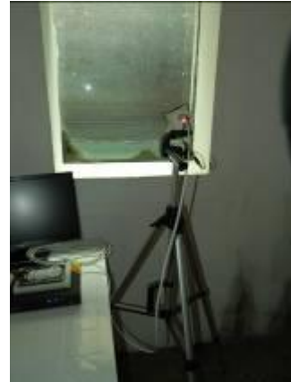
Figura 321 Monitoramento da Escada de Peixes é feito 24 horas, através de filmagem
