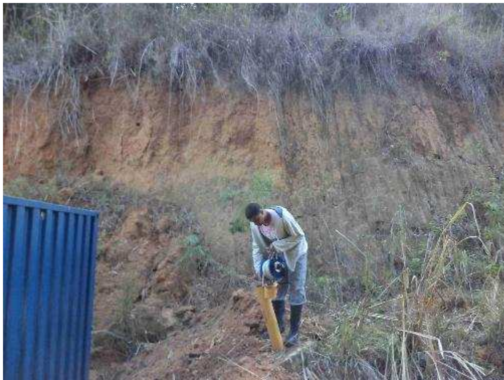
FOTOGRAFIA 18 - Piezômetro PML – 19 - Sítio Campo Alegre – Lixão de Anta – Piezômetro deslocado do eixo vertical. Foto 17/07/2014.
