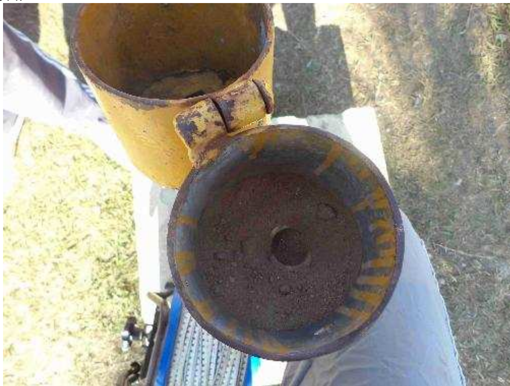
Fotografia 1. Piezômetro PML 27 (Estação de Anta) obstruído na profundidade 1,39m. Data: 13/08/2014.
