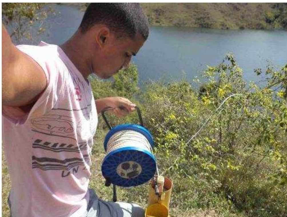
FOTOGRAFIA 17 - Piezômetro PML – 18 - Ponte do Macuco – Chiador. Foto 17/07/2014.
