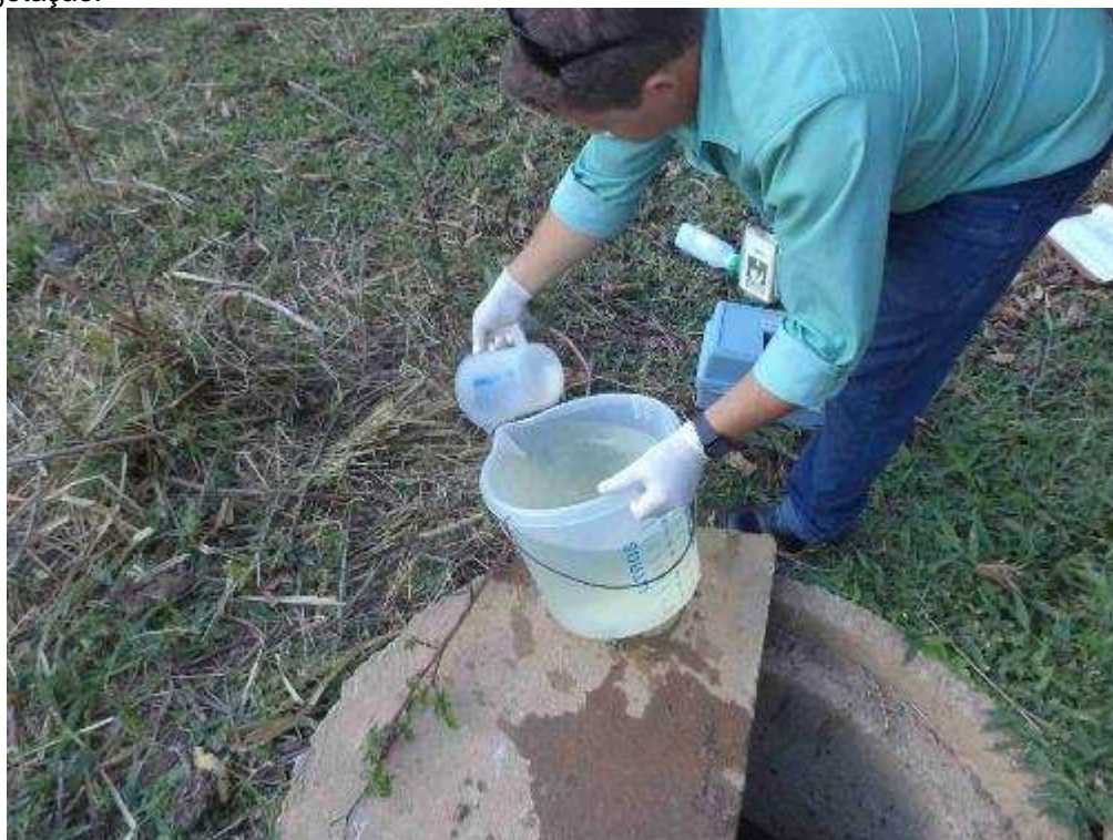
Fotografia 5. Poço Monitoramento PML – 14 (cacimba). Atentar para a situação do poço raso tomado pela vegetação.
