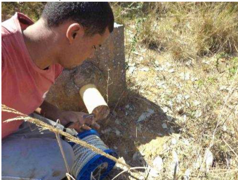
FOTOGRAFIA 19 - Piezômetro PML – 20 - Sítio Campo Alegre – Lixão de Anta – Piezômetro com a tubulação externa arrancada juntamente com a base. Foto 02/07/2014.
