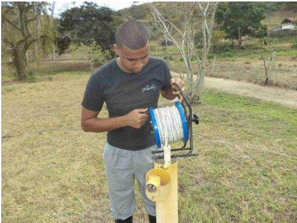
FOTOGRAFIA 10 - Piezômetro PML – 10 - Comunidade Grama. Foto 09/07/2014.
